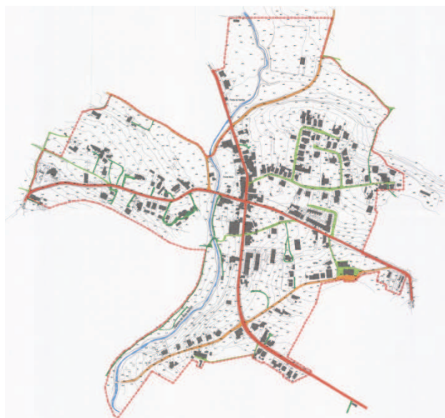
Figura 5 - Planta da caracterização dominante da Rede Viária incluída no PP de Pechão
